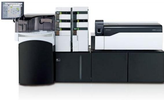
臨床検査装置（前処理装置および高速液体クロマトグラフ質量分析計）
